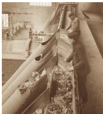
La gadoue est acheminée par un transporteur et aiguillée par des ouvriers pour remplir les goulottes d'alimentation des fours. Quatre portes sont percées dans la façade de chaque four et permettent aux ouvriers d'opérer l'étagage de la gadoue et d'enlever les mâchefers
