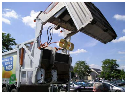
Intérieur de la benne bi compartimentée et caisson pour le verre (en l'air)
